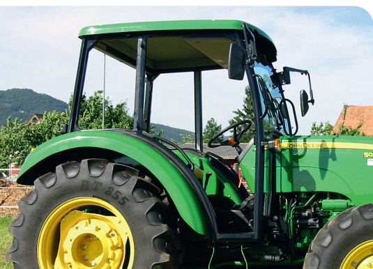
Viele Traktoren können mit einer Universal-kabine nachgerüstet werden. Bild: Franz Jäggi AG
