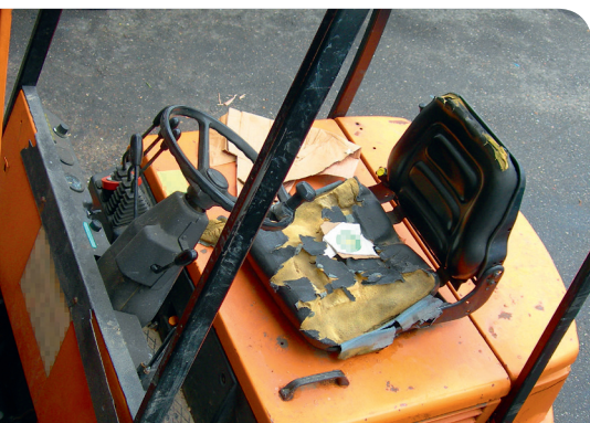
Sitze mit Defekten sollten nicht zuletzt auch der Gesundheit zuliebe ersetzt werden.
