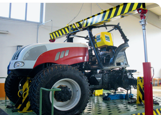
Bei der ROPS-Prüfung wird ein Fahrzeugüberschlag simuliert. Bild: Walter Winkler, HBLFA Francisco Josephinum
