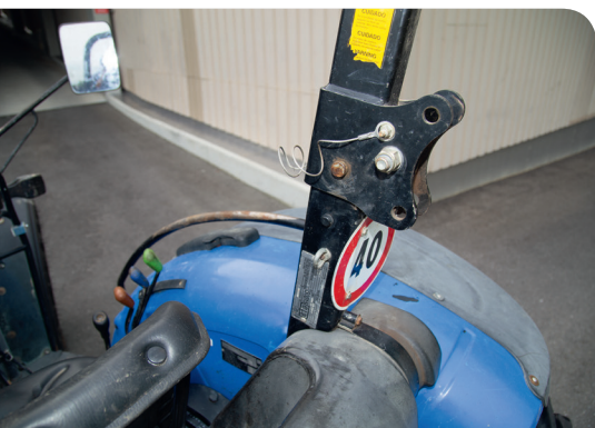
Klappbare Überrollbügel müssen unmittelbar nach jedem Einsatz wieder in Schutzstellung gebracht werden.
