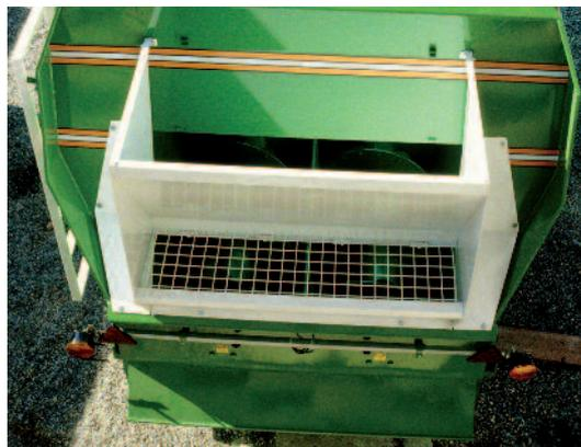
Bei laufendem Futtermischwagen darf nur mechanisch befüllt werden. Eine spezielle, mit Gitter abgedeckte Öffnung erlaubt es, Konzentrate gefahrlos beizumischen.
