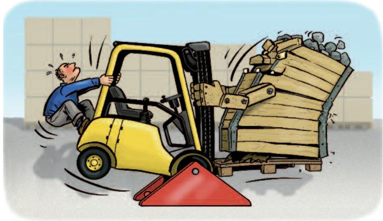
Die Tragfähigkeit ergibt sich aus dem Hebelgesetz. Der Drehpunkt ist das Vorderrad, das Gegengewicht ergibt sich aus allen Fahrzeugteilen, die hinter der Vorderachse liegen. Die aufzunehmende Last darf also nicht schwerer sein als das Gegengewicht. Zudem braucht es noch Reserven, um auch dynamische Kräfte aufzunehmen.
