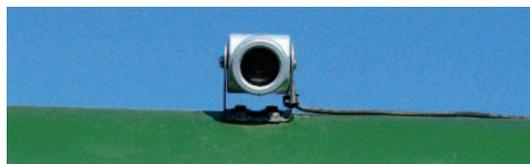
Mit Futtermischwagen muss im Hofbereich und in Siloanlagen häufig rückwärts gefahren werden. In diesen Situationen helfen Kameras die toten Winkel zu überblicken und damit Personen- und Sachschäden zu verhindern.
