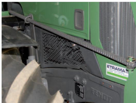
*Ein nützliches Hilfsmittel ist ein Reinigungsseisen. Dies kann helfen z.B. festgeklemmte Steine gefahrlos zu entfernen.*
