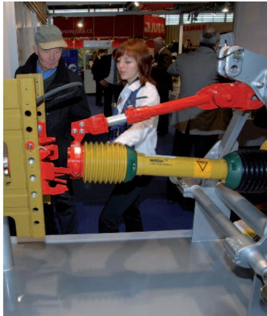
*Schnellkuppler und hydraulische Oberlenker machen das An- und Abkoppeln von Anbaugeräten sicherer und leichter. Einrichtungen, die das Koppeln der Gelenkwelle erleichtern, schaffen bis jetzt den Durchbruch nicht.*
