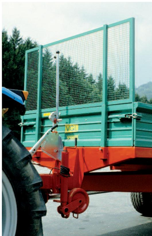
Das korrekt montierte Schutzgitter vorn schützt den Fahrer vor umherfliegendem Material.
