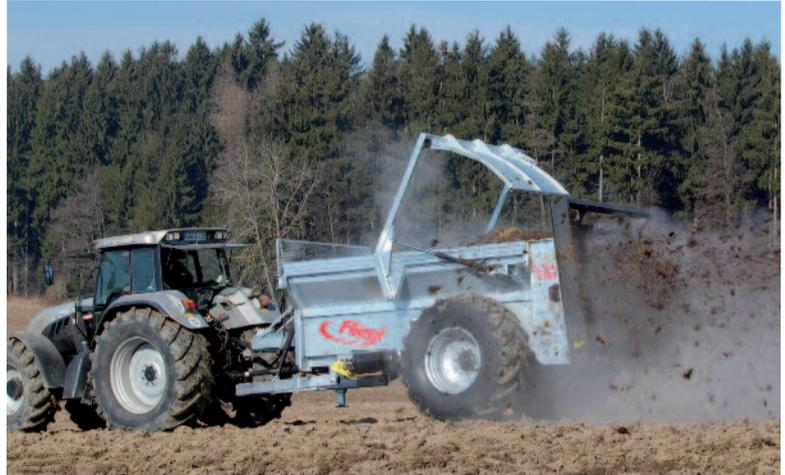
Der Miststreuer ist eine Landmaschine, die sehr stark strapaziert wird. Schon beim Beladen besteht Gefahr, dass Sicherheitselemente wie Frontschutzgitter oder Schutzabdeckungen durch den Lader beschädigt werden. Beim Streuen auf dem Feld werden die Beleuchtungsvorrichtungen verschmutzt oder gar beschädigt.
