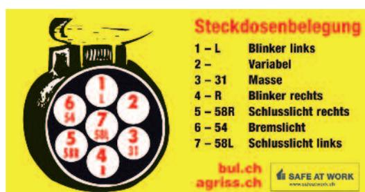
*Die elektrischen Einrichtungen an landw. Fahrzeugen sind häufig defekt. Dieser Kleber hilft, den richtigen Anschluss zu finden.*
