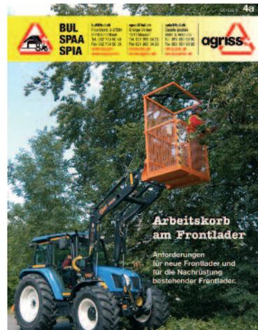
Das Heben von Personen erfordert an einem Frontlader sicherheitstechnische Anpassungen. Frontlader dürfen für Personenhub eingesetzt werden, wenn der Hersteller dies erlaubt oder wenn der Frontlader die Anforderungen erfüllt, welche in der BUL-Broschüre 4a «Arbeitskorb am Frontlader» beschrieben sind.
