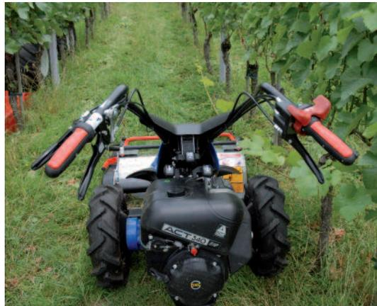
*Motoreinachser sind mit Tippschaltung ausgerüstet. Lässt die Bedienungsperson den Griff los, stellen Motor oder Antrieb sofort ab.*
