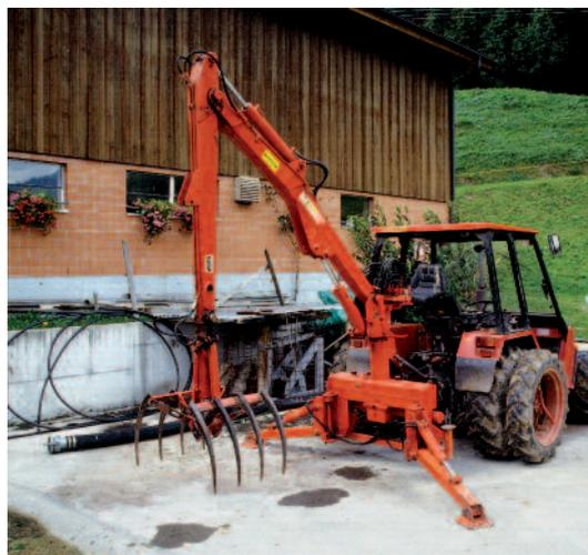
*Mehrere tödliche Unfälle ereigneten sich, weil die Bedienungsperson zwischen Lader und Kabine eingeklemmt wurde. Deshalb ist die Hubhöhe mechanisch zu begrenzen oder der Kran fest anzubauen.*
