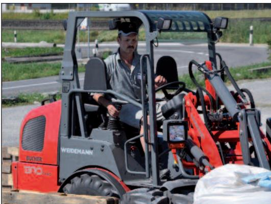
Wegen der Gefahr von herunterfallenden Materialien, ist ein Schutzdach erforderlich. Insbesondere Stapler und Hoflader können bei Fahrfehlern leicht kippen. Deshalb ist ein Rückhaltesystem vorgeschrieben.
