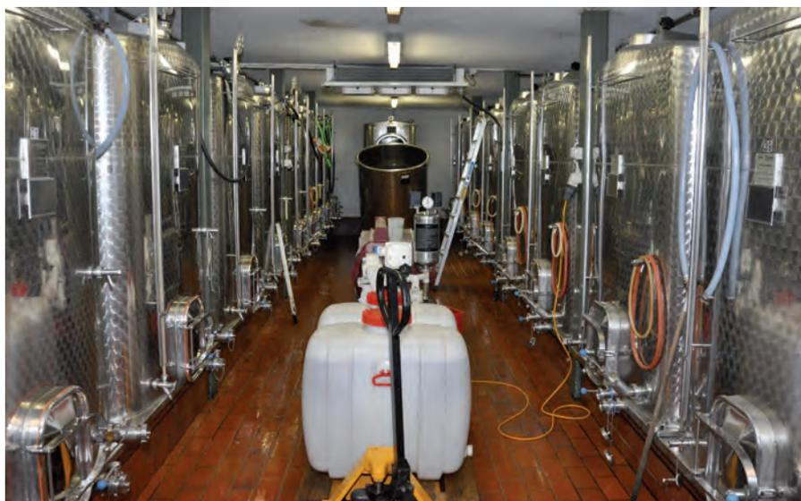
*Während der Gärung darf der Keller nur mit den nötigen Vorsichtsmassnahmen betreten werden. Gärgase füllen einen Kellerraum in kurzer Zeit. Diese Gase müssen daher während der Gärung laufend an der tiefsten Stelle des Raumes abgesaugt werden.*
