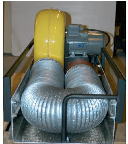
Mobile Gebläse können gezielt eingesetzt werden. Es besteht die Gefahr, dass sie im Notfall nicht am richtigen Ort sind.
