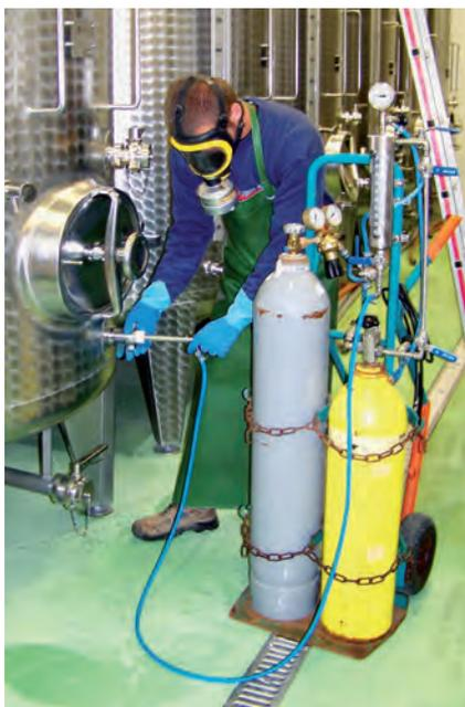
Mit dieser Einrichtung ist eine sichere Anwendung von SO<sub>2</sub> möglich. Der Kontakt mit SO<sub>2</sub> wird vermieden, zudem ist die nötige PSA zu tragen.
