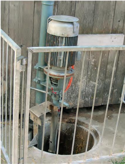
*Muss Gülle im Gebäude aufgerührt werden, ist eine ausreichende Durchlüftung nötig. Öffnungen sind gegen Einsturz zu sichern.*
