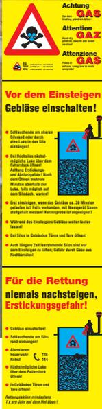
Praktisch und sicher sind fest installierte Entlüftungsanlagen, wie sie spezialisierte Firmen und die BUL anbieten. Jedes Silo muss an gut sichtbarer Stelle einen Warnkleber «Achtung Gas: Vor dem Einstieg gründlich durchlüften!» aufweisen.
