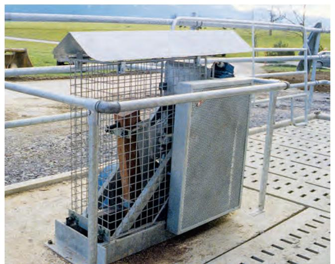
Der Lieferant des Rührwerks ist verpflichtet, die erforderlichen Schutzvorrichtungen mitzuliefern. Nach Wartungs- und Reparaturarbeiten sind diese sofort wieder anzubringen.
