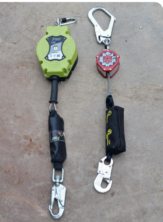
Verschiedene Höhengsicherungsgeräte mit Gurtband oder Stahlseil
