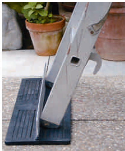
Das Leitern-Sicherungs-Set der BUL eignet sich zur Nachrüstung. Es besteht aus Sicherungsbügel und Haltegriff. Der Leiterstopper verhindert das Wegrutschen auf glattem Untergrund. Ein Leiterstopper kann mit einer Gummimatte und einem Stück Holz selber hergestellt werden.
