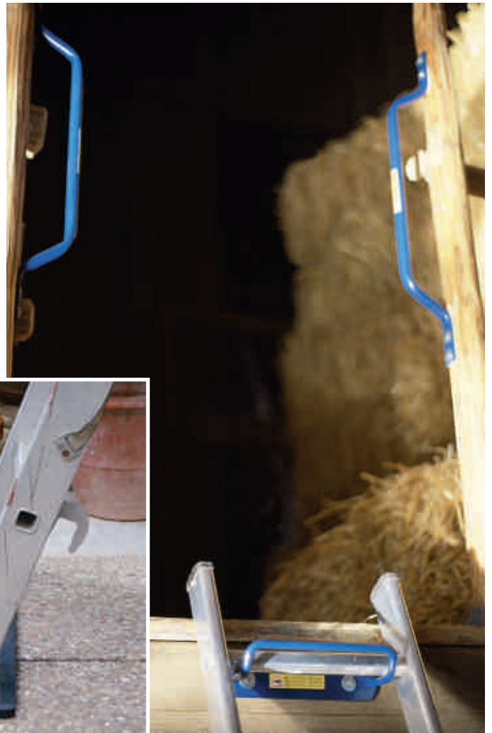
Das Leitern-Sicherungs-Set der BUL eignet sich zur Nachrüstung. Es besteht aus Sicherungsbügel und Haltegriff. Der Leiterstopper verhindert das Wegrutschen auf glattem Untergrund. Ein Leiterstopper kann mit einer Gummimatte und einem Stück Holz selber hergestellt werden.
