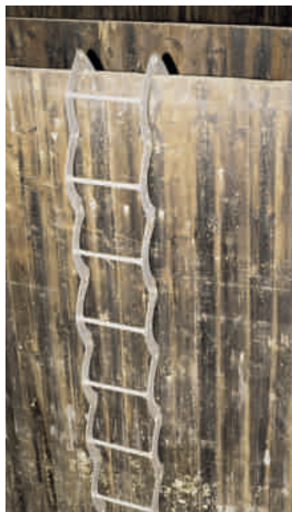
Mit einer Rolllleiter kann der Einstieg in ein Silo oder eine geschlossene Heubelüftung sicher werden.
