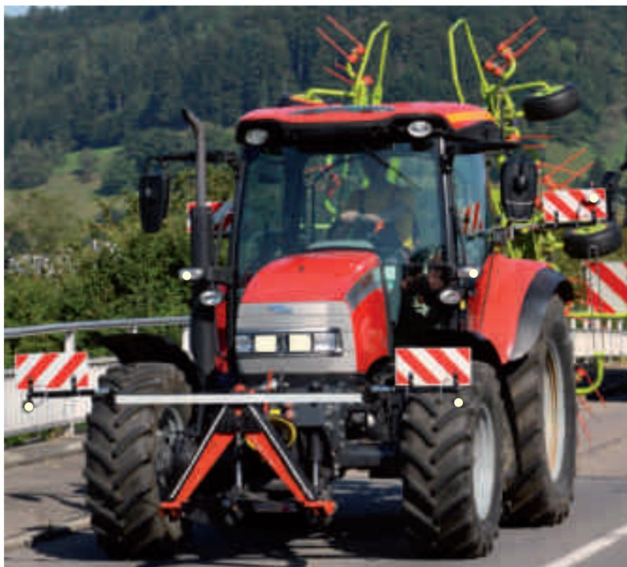
Seitlich vorstehende Fahrzeugteile, Anbaugeräte und Anhänger müssen auffällig rot/weiss (schwarz/gelb) gestreift gekennzeichnet sein. Die beste Wirkung auf den Gegenverkehr haben Markierungsflächen, die an der Fahrzeugfront angebracht sind.
