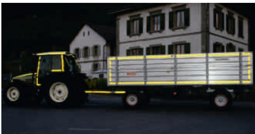
Ist ein Anhänger länger als 5 m, ist auf beiden Seiten mindestens ein roter oder oranger Rückstrahler erforderlich. Nachts und bei schlechter Sicht sind Fahrzeuge mit Konturmarkierung (Retroreflektierendes Klebeband) unübersehbar. (Art. 69 VTS).
