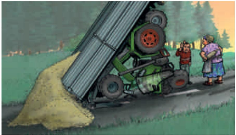
*Unfälle mit landwirtschaftlichen Fahrzeugen ereignen sich auch wegen ungenügender Bremsen. Vor jeder Fahrt ist eine Bremsprobe zu machen. Bei modernen Traktoren dürfen nicht nur Joystick oder Automatikschaltungen betätigt werden, auch die Anhängerbremse muss aktiviert werden.*
