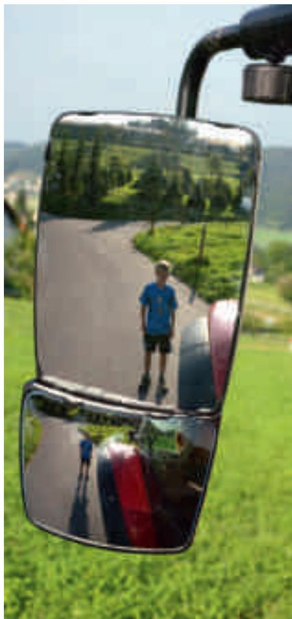
Rückspiegel müssen gross und genügend weit aussen angebracht sein und sich so verstellen lassen, dass die Fahrbahn seitlich neben dem Anhänger und mindestens 100 m weit nach hinten überblickt werden kann.
