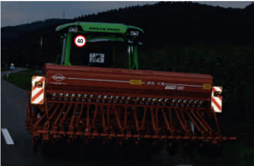
Geräteteile, die den Traktor seitlich um mehr als 15 cm überragen, müssen mit rot/weiss (gelb/schwarz) gestreiften Flächen, die retroreflektierend sein sollten, sowie Rückstrahlern oder Markierlichter, die von vorne und hinten sichtbar sind, gekennzeichnet sein. Spitzen, Schneiden und scharfe Kanten sind abzudecken. Werden die Lichter des Zugfahrzeugs verdeckt, sind Ersatzvorrichtungen anzubringen.
