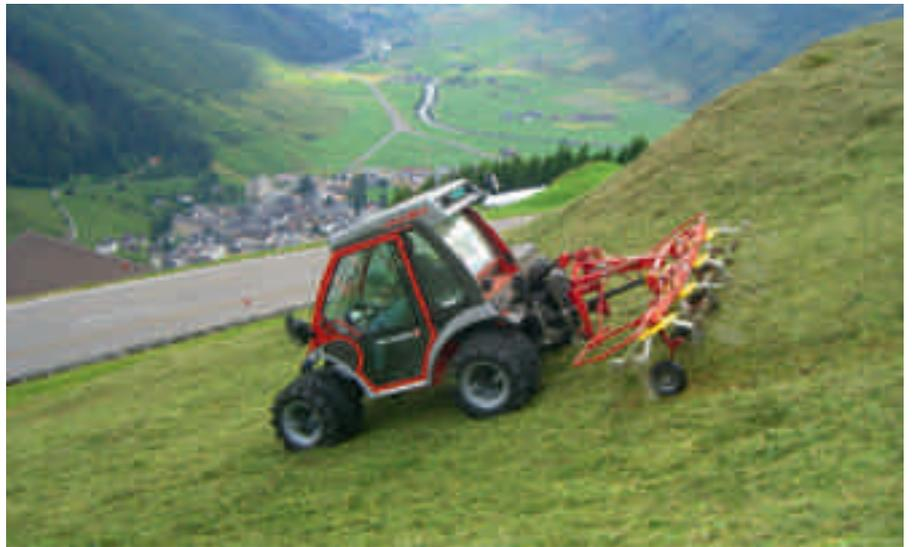
*Hanggeräteträger müssen den Einsatzbedingungen entsprechend ausgerüstet sein. Dazu gehören wirksame Bremsen, Gewichtsverteilung, Bereifung, Sicherheitskabine mit Türen und Sicherheitsgurte.*
