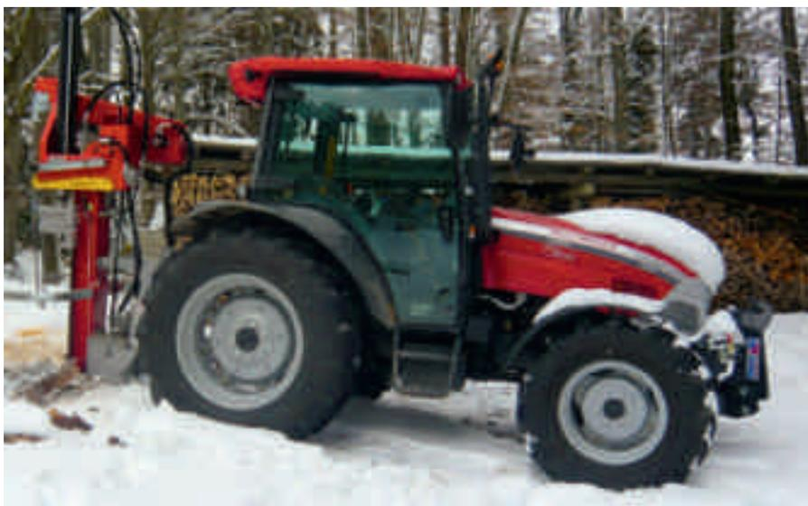
*Eine integrierte Fahrschutzkabine bietet nicht nur Schutz vor Kälte und Nässe, sondern auch vor Lärm und Staub. Der höhere Fahrkomfort steigert die Aufmerksamkeit und führt weniger zu Ermüdung.*
