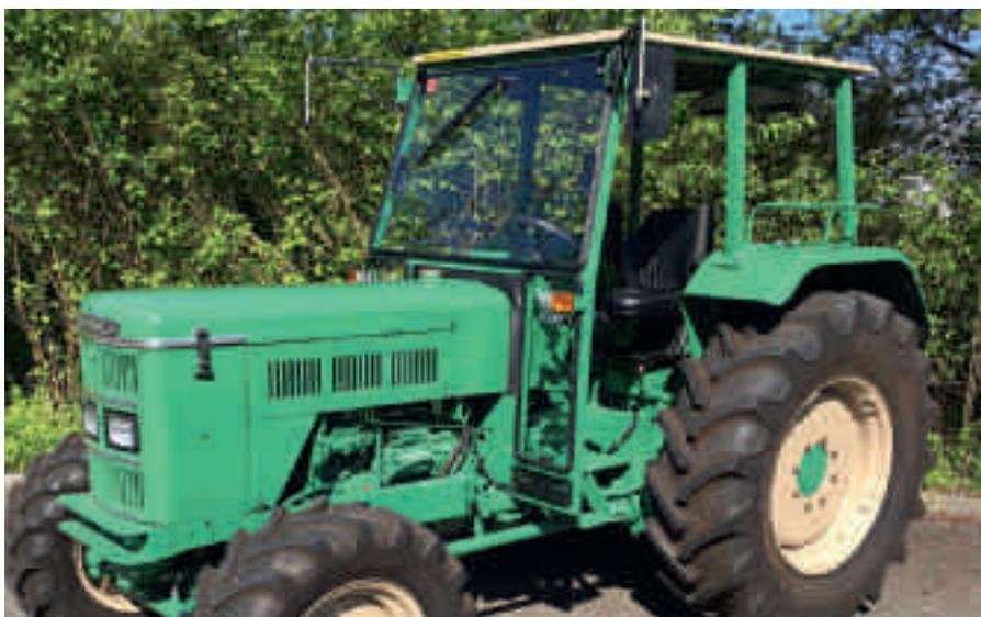
*Immer wieder werden Landwirte wegen Fehlen des Fahrschutzes getötet. Es ist nie zu spät, Alttraktoren nachzurüsten. Die sicherste und beste Nachrüstung ist eine komplette Kabine.*
