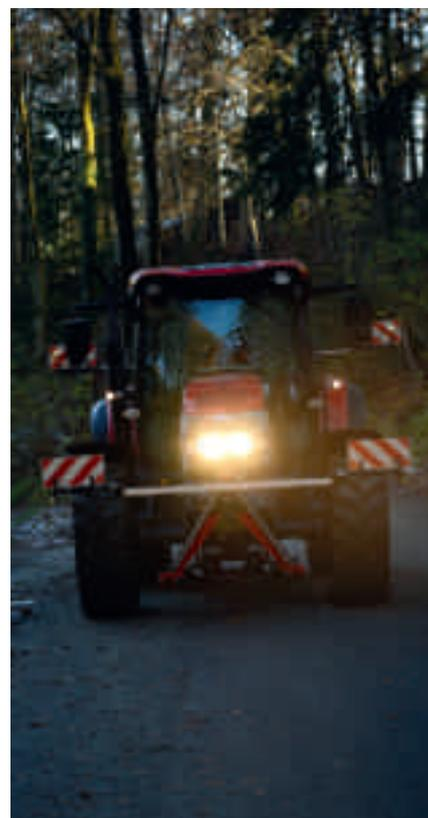
Die Lichter sind stets einzuschalten, auch am Tag. Es ist wichtig, dass alle Beleuchtungseinrichtungen funktionieren, damit auch vorstehende Teile sichtbar sind. LED-Leuchten sind wegen der erhöhten Lebensdauer von Vorteil.
