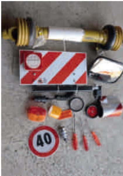
Beleuchtungsanlagen, Spiegel und Gelenkwellen müssen regelmässig kontrolliert und gewartet werden. Es ist zu empfehlen, Ersatzteile an Lager zu halten.
