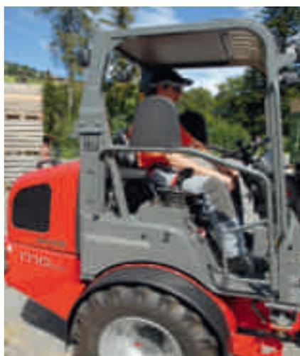
Seit 1.1.2010 sind neue Hofklader mit Fahrerschutz und Rückhaltesystem ausgerüstet. Alte Fahrzeuge je nach Einsatz nachrüsten.
