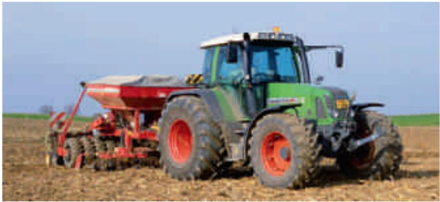
Traktoren mit Breitreifen und einer Gesamtbreite über 2,55 m sind Ausnahmefahrzeuge mit braunem Kontrollschild. Wichtig sind korrekte Markierung und Beleuchtung.
