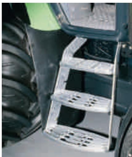
*Korrektcr Aufstieg: Leicht begehbar, rutschhemmend, ideale Stababstände und seitliche Anschläge.*
