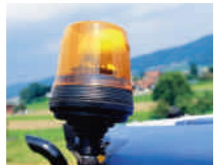
Drehlichter müssen im Fahrzeugausweis eingetragen sein. Sie dürfen nur gemäss Auflage verwendet werden, z.B. wenn Geräte breiter als 3 m sind.
