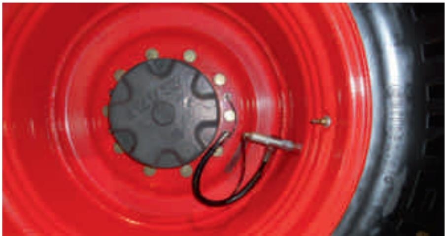
Mit einer Druckregelungsanlage kann der Reifendruck nach dem Feldeinsatz rasch soweit erhöht werden, wie er für die sichere Strassenfahrt erforderlich ist.
