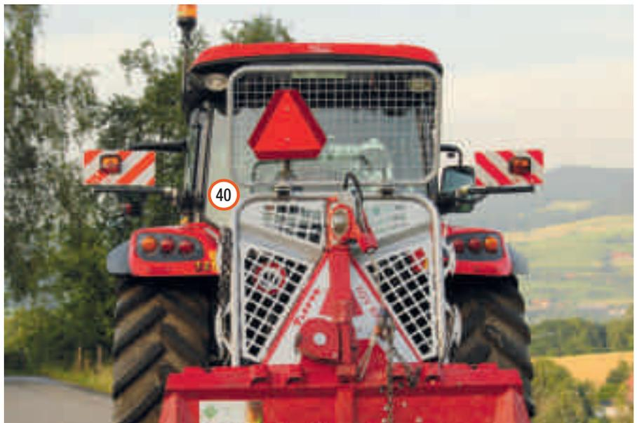
Zusätzliche Beleuchtungsvorrichtungen am Zugfahrzeug anstelle der Markierlichter können bei kurzen Anbaugeräten die verdeckte, originale Beleuchtungsvorrichtung ersetzen.
