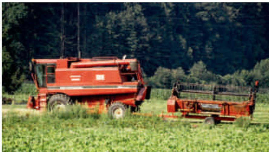
Mehr als 3,5 m breite Schneidwerke werden längs transportiert.
