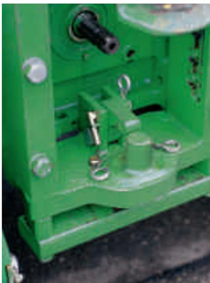
Die Untenanhängung mit Piton-fix erlaubt Stützlasten bis 3 t. Bei schweren Lasten können Schläge auftreten.
