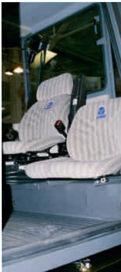
*Traktorsitze müssen gute Verstellmöglichkeiten und ergonomische Rückenstützen aufweisen. Solche mit Mängeln, dem Rücken zuliebe ersetzen oder reparieren. Eine regelmässige Wartung ist erforderlich.*
