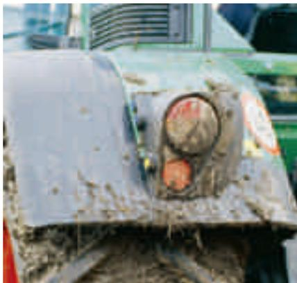
Der Fahrer ist dafür verantwortlich, dass sein Fahrzeug korrekt funktioniert. Deshalb sind Markierung, Lichter und Blinker regelmässig zu reinigen und zu kontrollieren.
