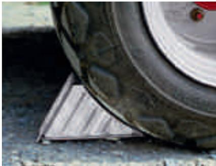
*Parkierte Motorfahrzeuge und Anhänger sind in Steigung und Gefälle mit einem Unterlegkeil zu sichern.*
