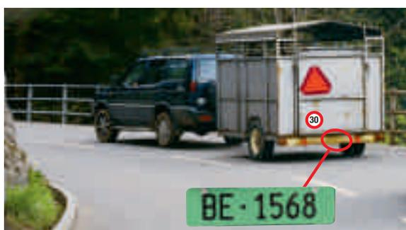
Werden landwirtschaftliche Anhänger mit einem Garantiegewicht von mehr als 1500 kg an Zugfahrzeugen mit Allradantrieb verwendet, ist ein grünes Kontrollschild erforderlich, die Höchstgeschwindigkeit beträgt 30 km/h. (Art. 72, c2 VZV)
