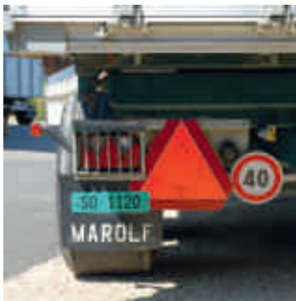
Landwirtschaftliche Transportanhänger müssen mit fest angebrachten Beleuchtungsvorrichtungen ausgerüstet sein. Robuste, geschützte Anlagen funktionieren länger.
