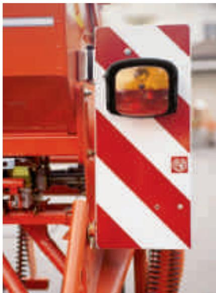
Anbaugeräte, welche die Beleuchtung des Traktors verdecken, müssen mit Ersatzvorrichtungen ausgerüstet werden.
