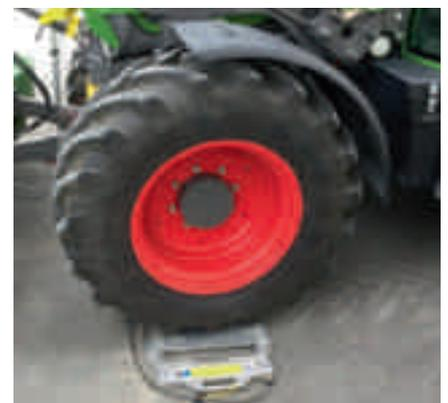
Die zulässige Vorderachslast und die Tragfähigkeit der Reifen dürfen nicht überschritten werden. (Art. 164 Abs. 1 VTS)
