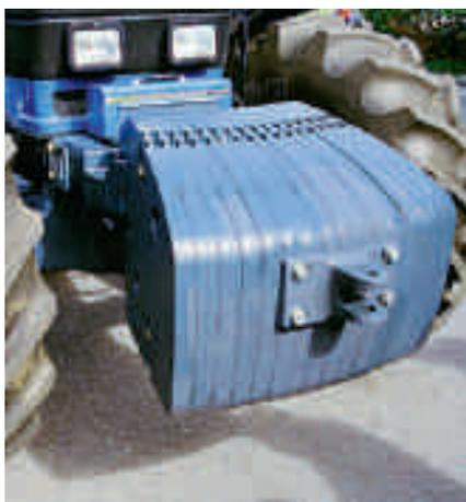
Die Frontachse muss mindestens mit 20 % des Betriebsgewichtes belastet sein. Frontgewichte sollten sich einfach an- und abbauen lassen.
