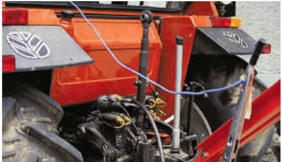
*Farmerstoppbremsen stets durch ein Seil mit dem Traktor verbinden, selbst wenn hydraulische Bremsen aufgebaut sind. Achtung: Farmerstoppbremsen erfüllen die Anforderungen häufig nicht mehr.*
