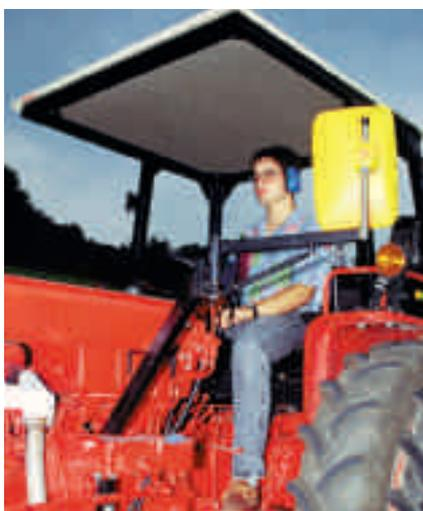
*Ebenfalls zur Nachrüstung eignen sich Sicherheitsrahmen oder Sturzbügel. Ein Sicherheitsgurt darf nicht fehlen.*
