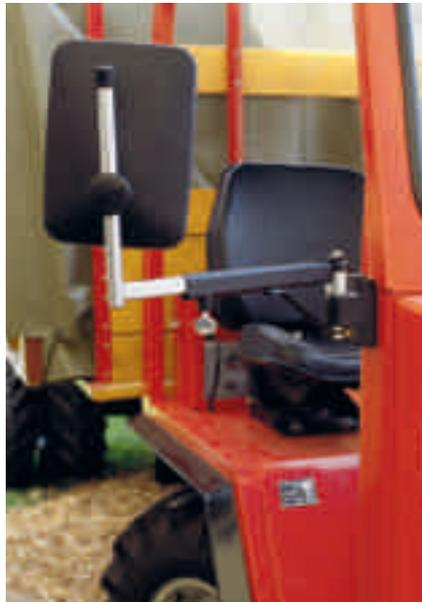
*Gute Lösung einer ausziehbaren Halterung für Transporterspiegel.*
