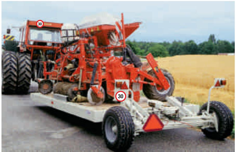
Praktischer hydraulisch absenkbarer Transportwagen für Anbaugeräte. Sind diese breiter als 3,5 m, müssen sie längs transportiert werden.
