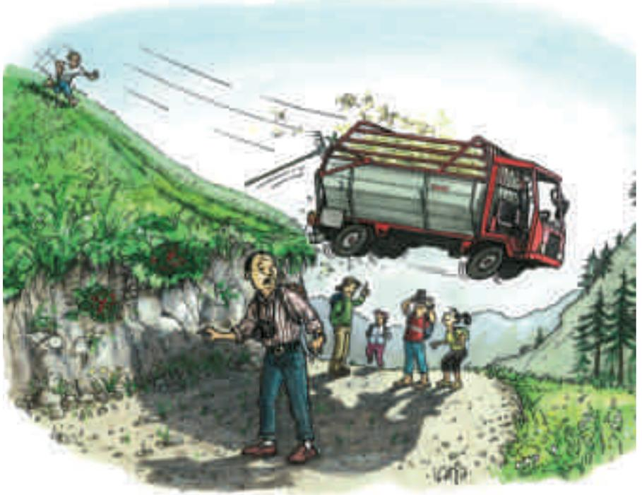
Im Hanggelände müssen die Einsatzgrenzen berücksichtigt werden. Wer den Transporter stehen lässt, muss ihn zusätzlich, z.B. mit Unterlegekeilen sichern, die Handbremse reicht oft nicht.
