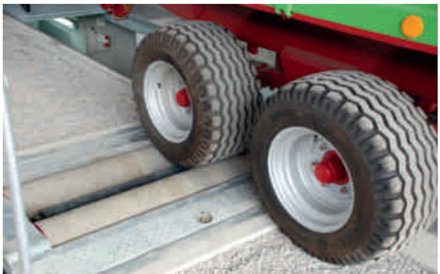
*Anhängerbremse müssen geprüft und auf das Zugfahrzeug abgestimmt sein. Ein Rollenprüfstand bietet die beste Prüfmöglichkeit.*
