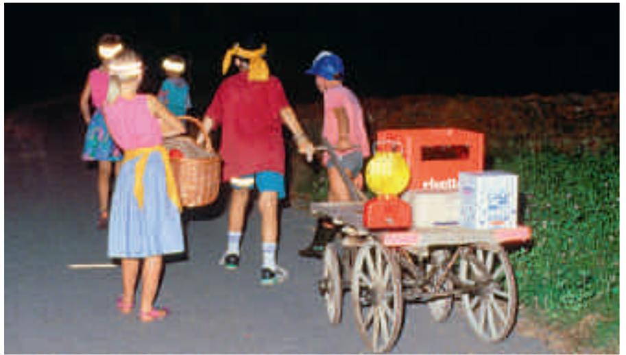
Für die Beleuchtung von Handwagen und Veloanhängern sind Baustellenlampen mit Dauerlicht geeignet. Reflexmaterialien erhöhen die Sicherheit.
