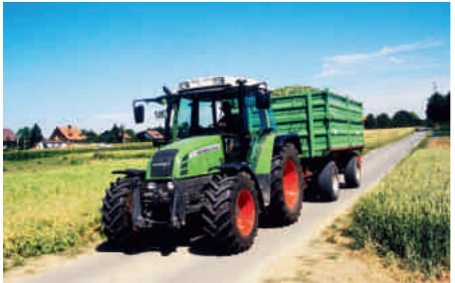
Die Bremsprobe vor der Abfahrt ist wichtig. Dabei wird auch der Speicher für die hydraulische Abreissbremse gefüllt.
