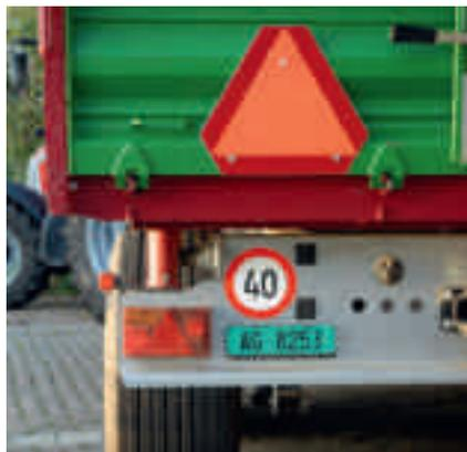
Heckmarkierungen können auch am Gummipendel oder mit Wechseladapter montiert, oder als Folie aufgeklebt werden.
