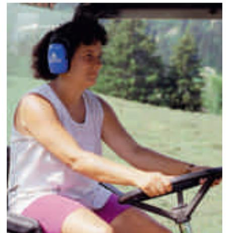
*Hanggeräteträger weisen in der Regel einen Lärmpegel von mehr als 85 dBA auf, deshalb sind Gehörschutzmittel zu tragen.*
