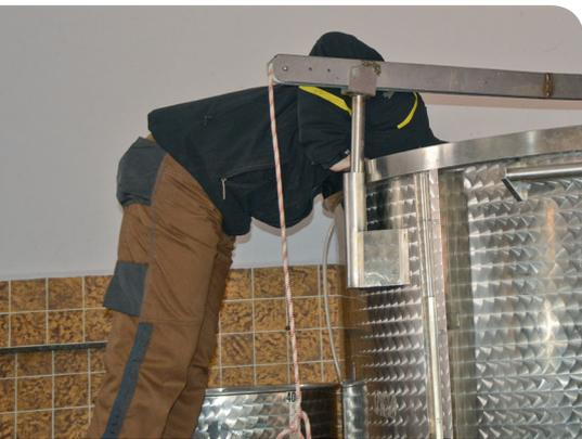
En se penchant sur une cuve, on inhale facilement du CO<sub>2</sub>.
