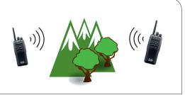
La portée entre les appareils radio dépend du terrain, des arbres et de la puissance d'émission. Les systèmes radio avec Bluetooth atteignent 300 à 600 m en forêt, les appareils radio PMR jusqu'à 1000 m.
