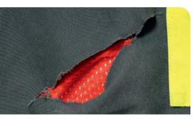
Malgré toutes les précautions, les pantalons anticoupures peuvent être endommagés par la chaîne de la tronçonneuse. La règle est la suivante : seule la couche supérieure du tissu peut être réparée. Dès que la doublure de protection contre les coupures est visible, le pantalon doit être remplacé.
