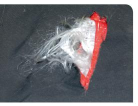
Les pantalons anticoupures contiennent une doublure en fils solides. Ceux-ci sont arrachés par la tronçonneuse et bloquent le pignon d'entraînement et la chaîne. Un pantalon endommagé de la sorte ne doit pas être réparé.
