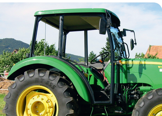
De nombreux tracteurs peuvent être rééquipés d'une cabine universelle. Photo : Franz Jäggi AG
