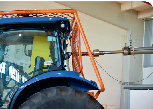
Les tracteurs forestiers sont protégés contre la chute et la pénétration de parties d'arbres par des FOPS et OPS spécialement renforcés. Photo : Walter Winkler, HBLFA Francisco Josephinum
