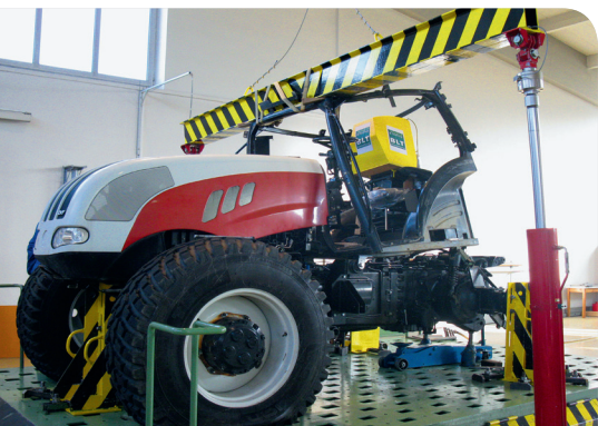
L'expertise d'un ROPS consiste à simuler un renversement de véhicule. Photo : Walter Winkler, HBLFA Francisco Josephinum
