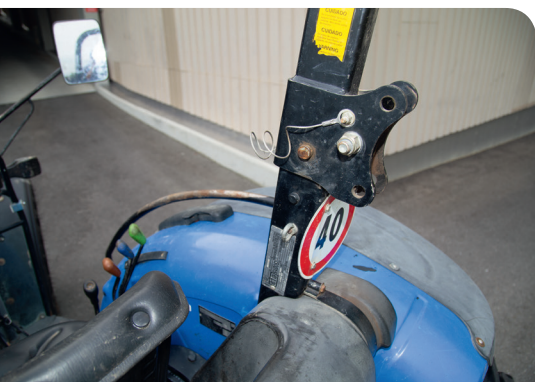
Les arceaux de sécurité rabattables doivent être immédiatement remis en position de protection après chaque utilisation nécessitant son abaissement.
