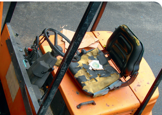
Les sièges défectueux devraient être remplacés, notamment pour des raisons de santé.
