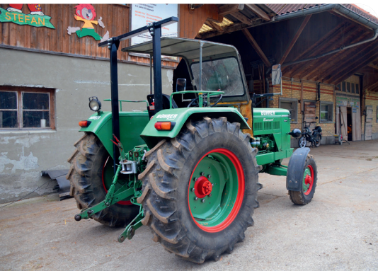
La rééquipement des arceaux de sécurité doit être confié à des spécialistes.
