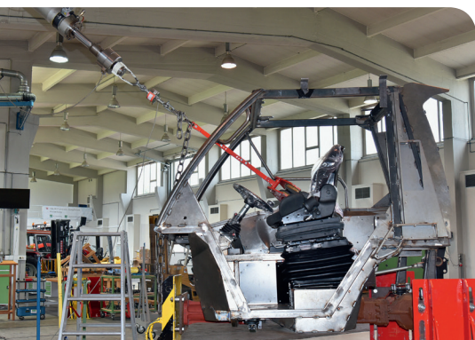
Les ancrages des sièges et des ceintures de sécurité doivent présenter la résistance requise. Photo : Walter Winkler, HBLFA Francisco Josephinum
