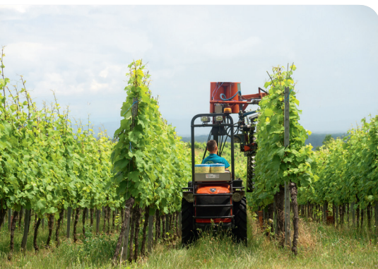
Risque de renversement accru à cause d'une surface d'appui étroite, un centre de gravité haut placé et une machine décalée latéralement.
