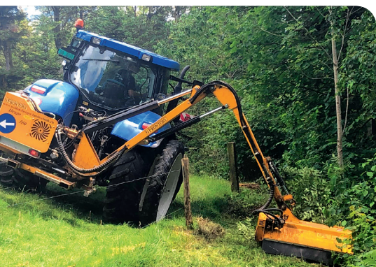
L'utilisation de roues jumelées déplace les lignes de renversement et rend le véhicule plus stable.
