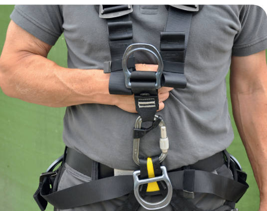
Le poing permet de vérifier si le harnais a été suffisamment serré.
