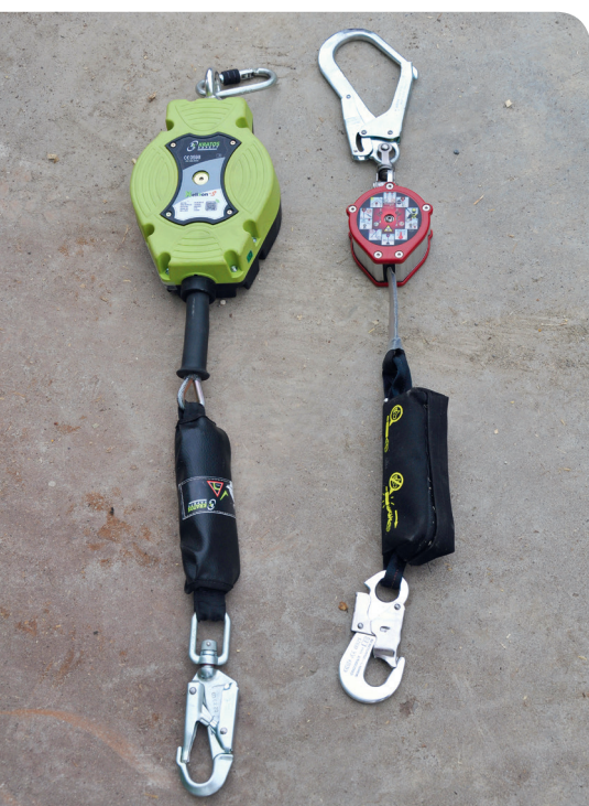
Différents antichutes à rappel automatique avec sangle ou câble d'acier
