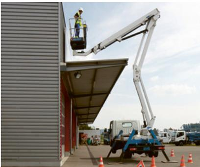
7 Plateforme élévatrice mobile de personnel multidirectionnelle non automatisée
