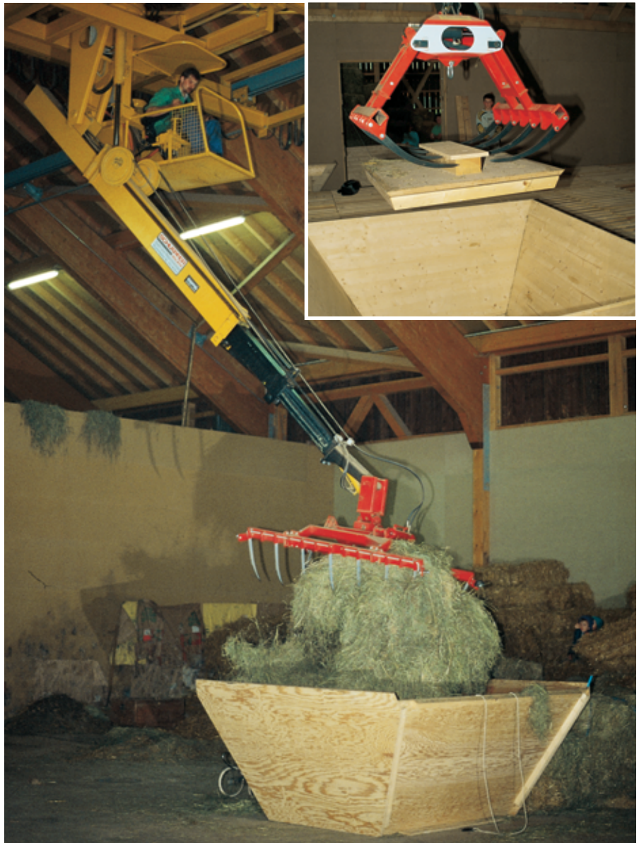
Protection de l'ouverture avec un entonnoir et un couvercle appropriés.
