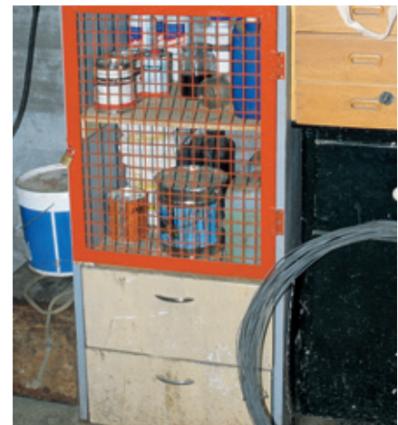
Dans l'atelier également, les substances dangereuses doivent être gardées sous clé. En outre, ce genre de lieu doit être bien aéré.
