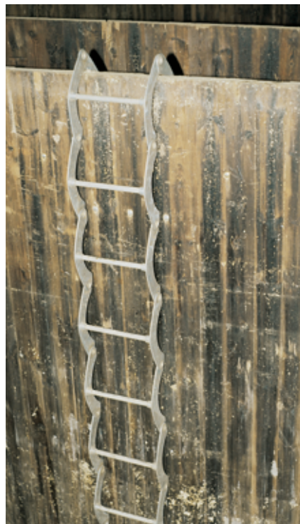
Une échelle déroulante permet de sécuriser l'accès dans un séchoir ou un silo.
