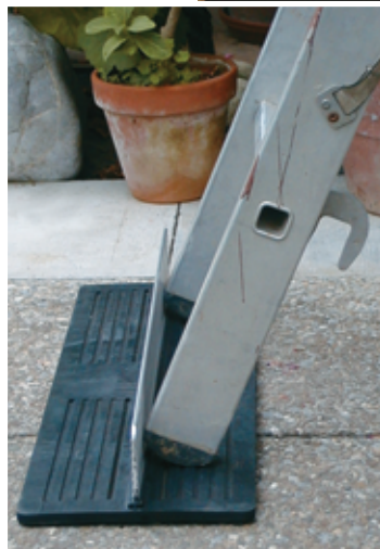
Le set assure-échelle du SPAA convient parfaitement pour l'équipement après-coup. Il se compose d'un arceau et d'une poignée de maintien. Le stop-échelle évite le dérapage sur une surface lisse. Un stop-échelle peut être fabriqué soi-même avec un matelas en caoutchouc et un bout de bois.
