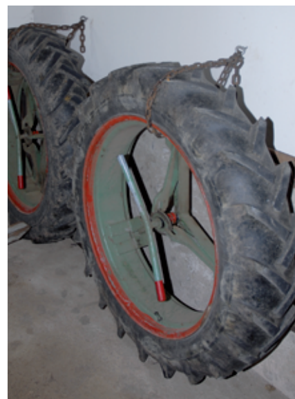
Les roues jumelées déposées doivent toujours être attachées comme ceci pour ne pas mettre en danger les enfants.
