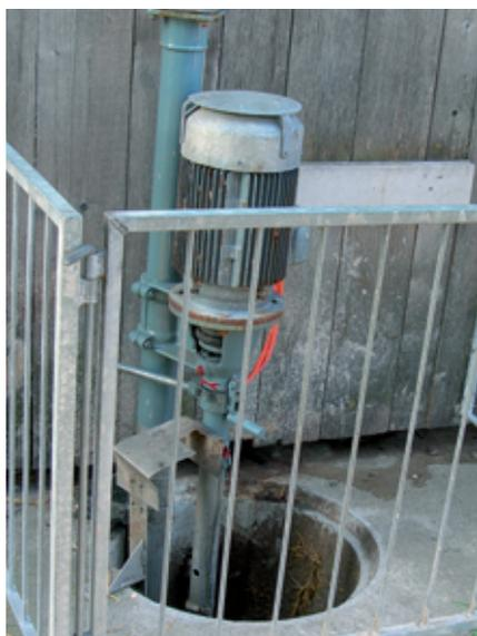
*Si du lisier doit être brassé dans le bâtiment, une aération suffisante est nécessaire. Les ouvertures doivent être sécurisées.*
