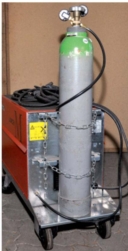
Les bouteilles de gaz doivent toujours être attachées et transportées avec soins.
