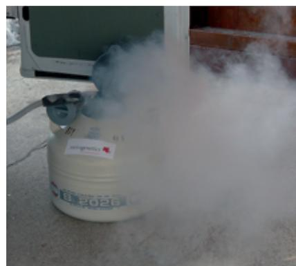
Lors du stockage, du transport et de l'usage d'azote liquide, il faut veiller à une aération suffisante. La manipulation de conteneurs à azote liquide ne doit être faite que dehors ou dans des locaux bien aérés.
