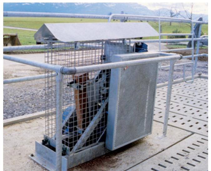
*Le fournisseur du brasseur à lisier est tenu de livrer les installations de protection nécessaires. Après l'entretien et les réparations, il faut immédiatement les remettre à leur place.*
