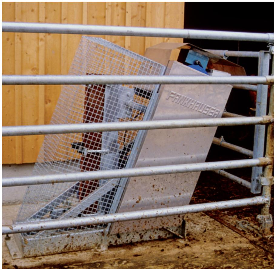
*Les brasseurs doivent être construits et installés de manière à remplir les exigences de la Directive «Machines» et à être utilisés sans dangers. Lors de jours sans vent ou de foehn, les gaz émis peuvent se révéler dangereux. Les dangers dus aux gaz doivent être considérés lors de réparations ou d'entretiens éventuels.*
