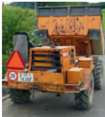
Les machines de chantier, les transporteurs, les faucheuses à deux essieux et les véhicules similaires doivent avoir un triangle véhicule lent.
