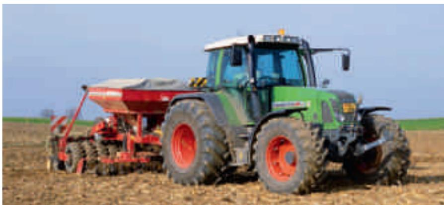
Les tracteurs munis de pneus larges d'une largeur totale supérieure à 2,55 m sont considérés comme véhicules spéciaux et doivent être immatriculés en plaque brune. Ils doivent être particulièrement bien signalisés et éclairés.
