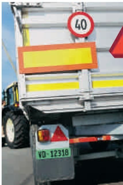
Les panneaux rectangulaires peuvent être montés pour compléter le triangle véhicule lent.
