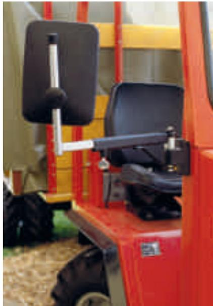
Bon exemple de rétroviseur avec support télescopique pour transporteur.
