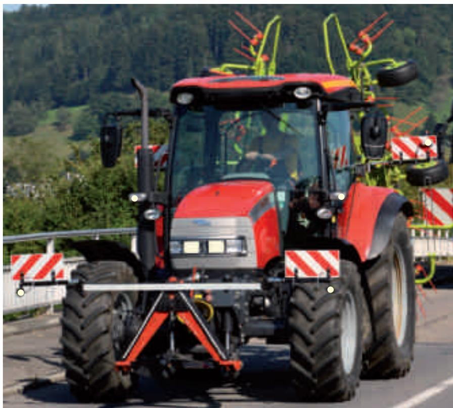
Les parties du véhicule faisant saillie latéralement, les accessoires et les remorques doivent être marqués avec des panneaux à rayures rouges/blanc (noirs/jaunes) de manière à être visible. Le meilleur effet sur le contre-traffic est celui des surfaces de marquage situées à l'avant du véhicule.
