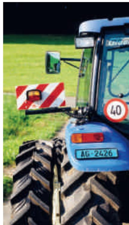
Lorsque des roues jumelées sont utilisées, le véhicule doit être muni de panneaux rouge/blanc ou noir/jaune. Les raies doivent être rétro-réfléchissantes. Des feux ou des feux de gabarit sont nécessaires.
