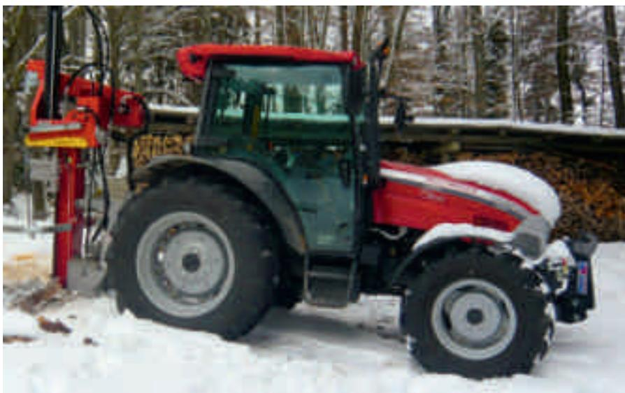
*Une cabine de sécurité intégrée ne protège pas seulement du froid et de la pluie, mais aussi du bruit et de la poussière. Le confort augmente les capacités d'attention et diminue la fatigue.*
