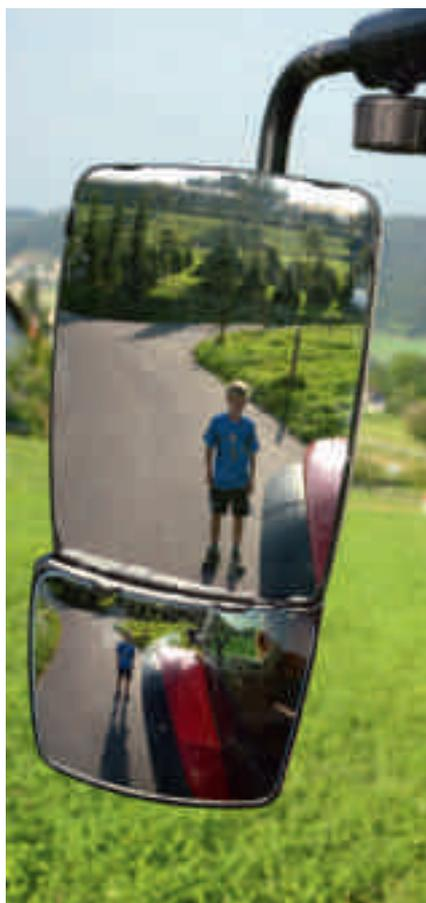
*Les rétroviseurs doivent être suffisamment grands, placés bien à l'extérieur et réglables, de manière à voir la chaussée de côté et en arrière de la remorque à au moins 100 m.*
