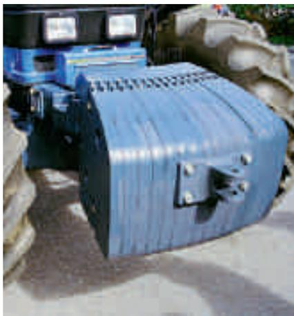
L'axe directionnel doit être chargé d'au moins 20 % du poids effectif. Les contrepoids doivent pouvoir se monter et se démonter facilement.
