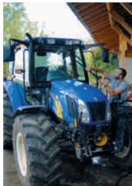
Les rétroviseurs, les vitres, les projecteurs, les feux et clignotants doivent être maintenus propres.
