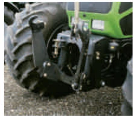
Les bras inférieurs du relevage avant doivent être signalés, démontés ou relevés.
