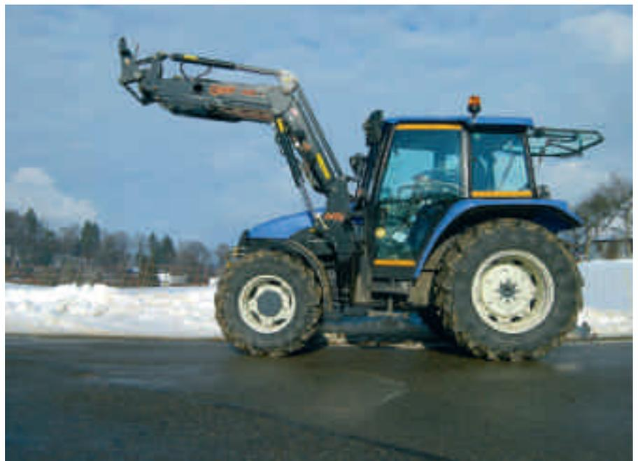
Suivant le type de chargeur, de tracteur ou d'accessoire, il faut lever ou baisser le chargeur pour rouler. La hauteur influence le champ de vision, le centre de gravité, le comportement au freinage et la stabilité du tracteur, surtout en courbe. Pas de charge sur l'accessoire. Hauteur maximale : 4 m.
