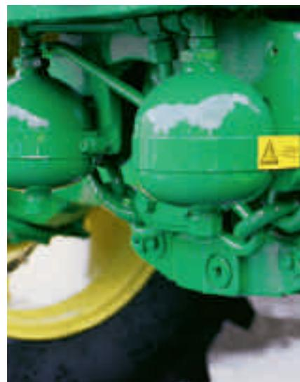
*Une suspension du pont avant et de la cabine apporte plus de confort, pour ménager le dos et le matériel.*
