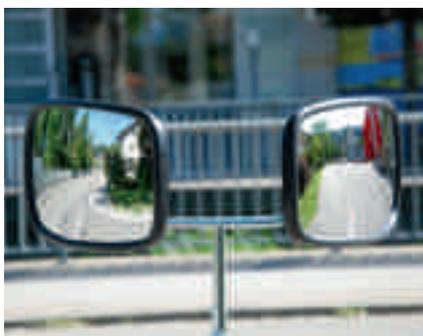
Les rétroviseurs de vision latérale neufs doivent avoir une surface de 500 cm<sup>2</sup> et être montés en format paysage.
