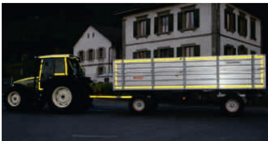
Les remorques d'une longueur supérieure à 5 m doivent être équipées sur le côté d'au moins un catadioptré orange ou rouge. La nuit et en cas de mauvaise visibilité, les véhicules munis d'un marquage de contour (ruban adhésif rétro réfléchissant) sont mieux visibles (art. 69 OETV).
