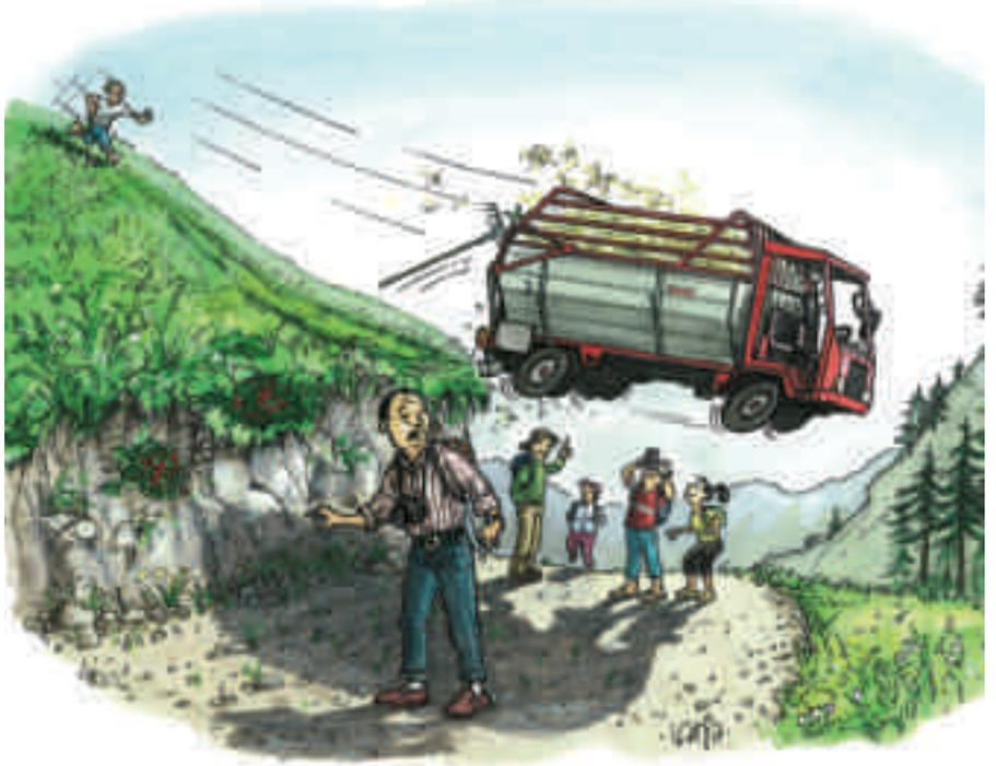
*Dans les terrains en pente, les limites d'utilisation doivent être respectées. Si l'on laisse le transporteur stationné en pente, il faut le sécuriser, p. ex. avec des cales. Souvent, le frein à main ne suffit pas.*
