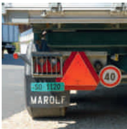
Les remorques de transport agricoles doivent être équipées d'une installation de feux arrière et clignotants fixe. Une installation robuste et bien protégée dure plus longtemps.
