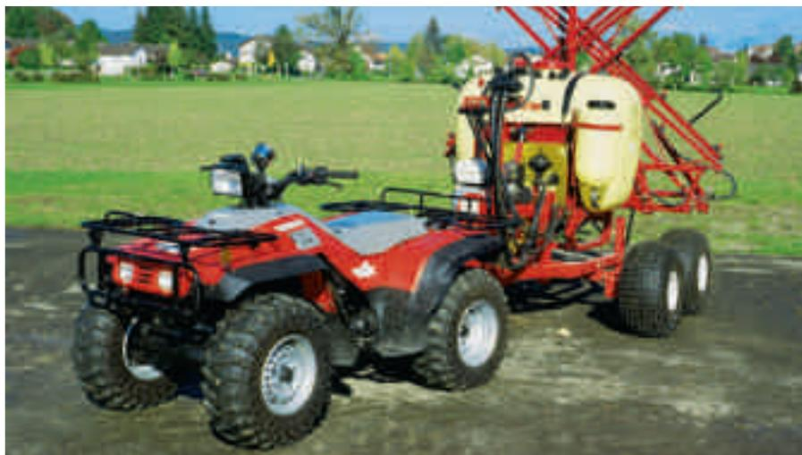
La charge remorquable pour les quadricycles à moteur figure dans le permis de circulation. Pour profiter de la totalité de la charge, les freins de la remorque sont déterminants.
