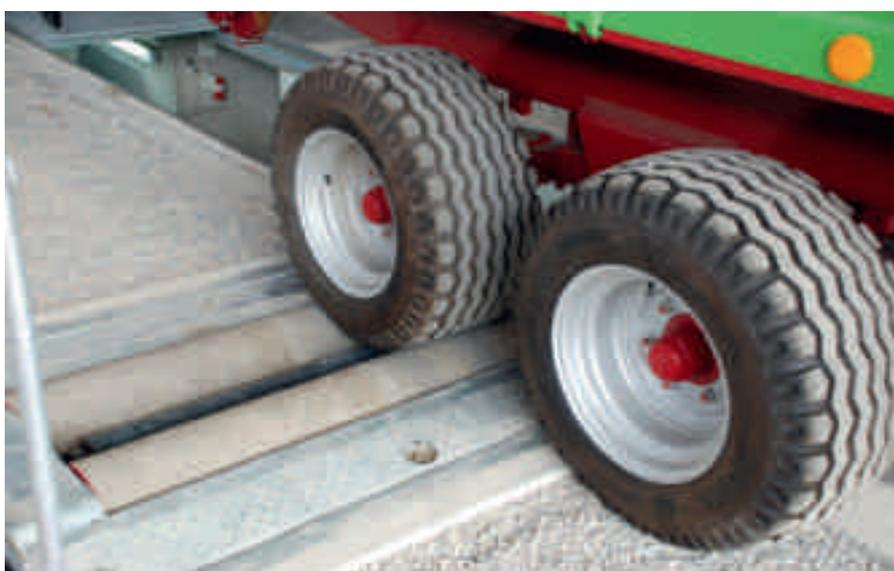
Les freins hydrauliques de remorques doivent être bien réglés par un spécialiste, à l'aide d'un banc d'essai, afin qu'ils correspondent au véhicule tracteur.
