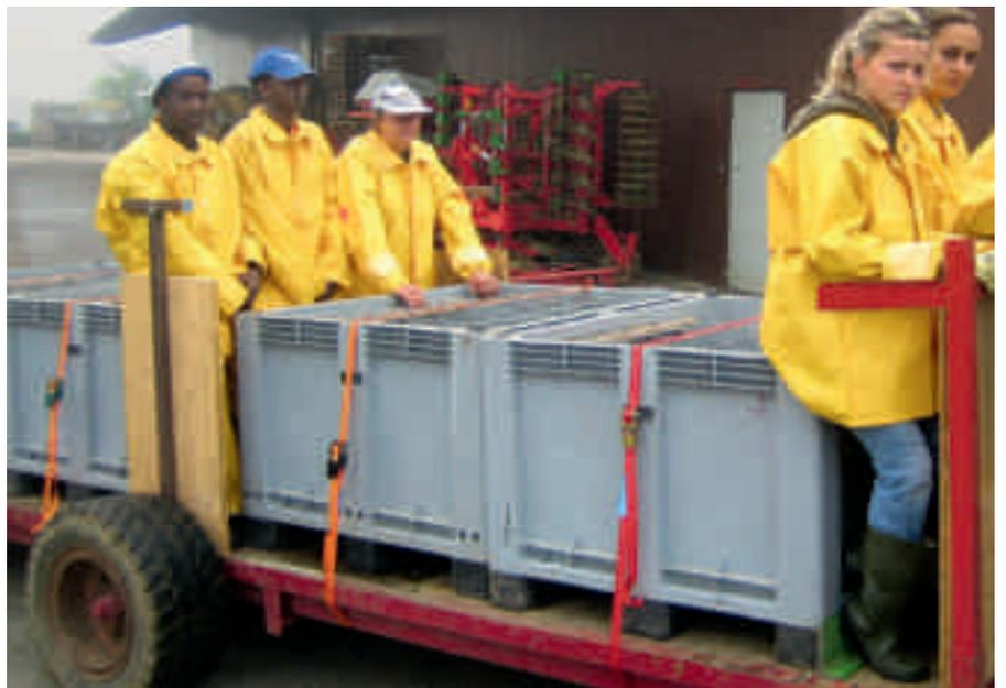
Les passagers peuvent aussi prendre place sur le pont ou sur la charge, pour autant qu'une protection suffisante soit assurée.
