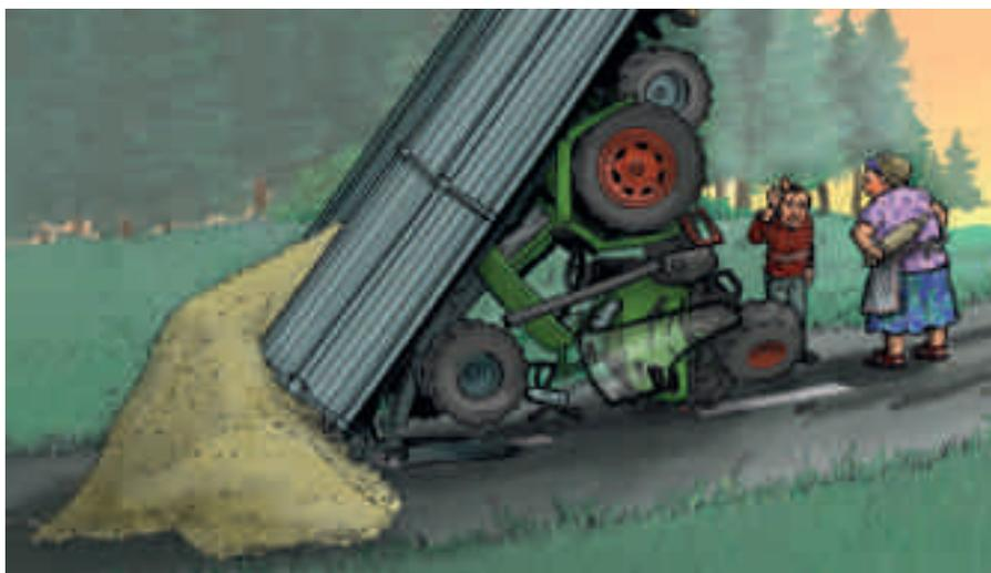
Bien des accidents avec des véhicules agricoles surviennent aussi du fait de freins insuffisants. Testez les freins avant chaque départ ! Avec les tracteurs modernes à transmission continue, il ne suffit pas d'actionner le joystick ou de rétrograder, il faut aussi actionner le frein de service de la remorque.
