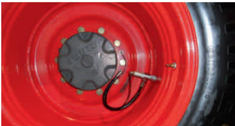
En sortant du champ, un système de régulation de pression permet d'augmenter rapidement la pression des pneumatiques, nécessaire à la conduite sûre sur route.
