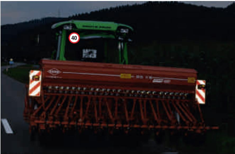
Les parties des outils portés qui dépassent le tracteur de plus de 15 cm doivent être signalisées à l'aide de panneaux rayés rouge/blanc (noir/jaune) et de réflecteurs, visibles depuis l'avant et l'arrière. Ils peuvent être rétro réfléchissants. Les pointes, couteaux et arêtes tranchantes doivent être protégés. Lorsque les feux et clignotants du tracteur sont cachés, il faut une installation de remplacement.
