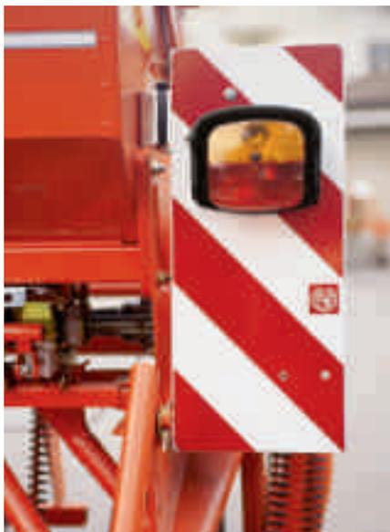
Les outils portés masquant l'arrière du tracteur doivent être équipés d'origine de feux et de clignotants.
