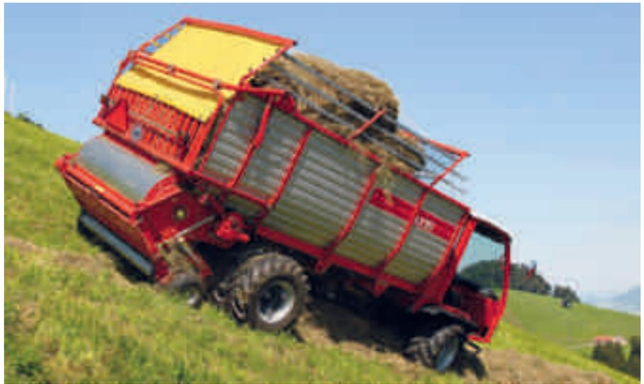
Les transporteurs munis d'un agrégat porté ont une répartition du poids idéale pour la circulation sur route et dans le terrain. Utilisés sans outil porté, ils sont très lourds à l'avant; des contrepoids doivent alors être montés à l'arrière.
