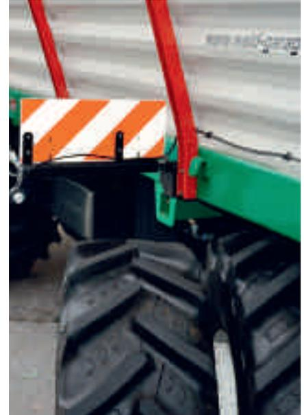
Dans le cas des transporteurs également, les roues faisant saillie latéralement doivent être marquées avec des surfaces rayées rouge/blanc (ou noir/jaune) et de nuit avec des catadioptrés ou des feux de gabarit.
