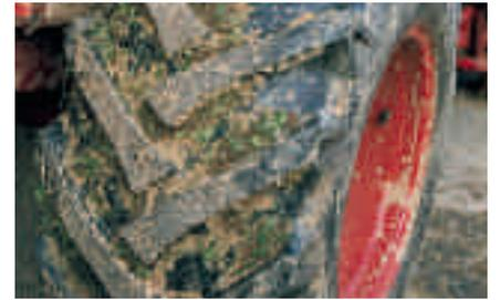
*Les pneus à profil tracteur améliorent l'effet de freinage et la capacité à circuler dans les pentes.*
