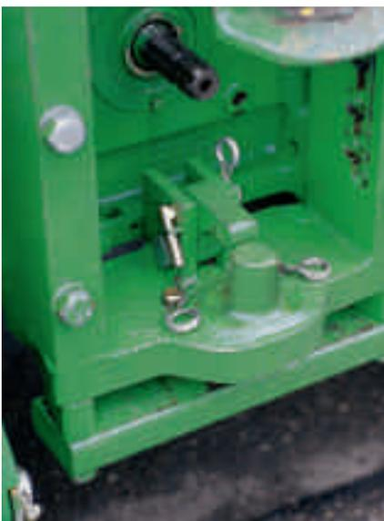
Attelage par le bas avec un piton permet d'utiliser la charge du timon maximale de 3 t. Des à-coups peuvent se produire avec des charges lourdes.
