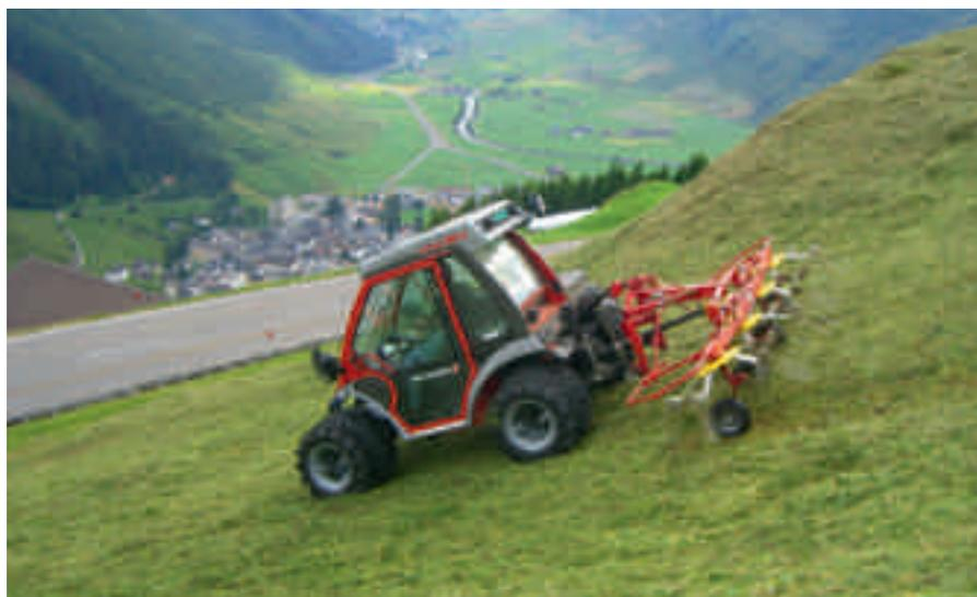
*Les porte-outils de montagne doivent être équipés selon les conditions d'utilisation. On y inclut des freins efficaces, une bonne répartition des masses, les pneus, la cabine de sécurité avec des portes et une ceinture de sécurité.*
