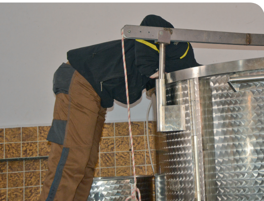
Quando ci si sporge all'interno di un serbatoio di fermentazione, anche la testa è immersa nel CO 2 .
