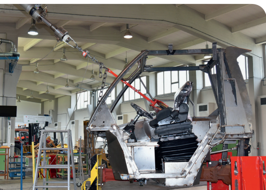
Gli ancoraggi dei sedili e delle cinture di sicurezza devono avere la resistenza richiesta. Immagine: Walter Winkler, HBLFA Francisco Josephinum
