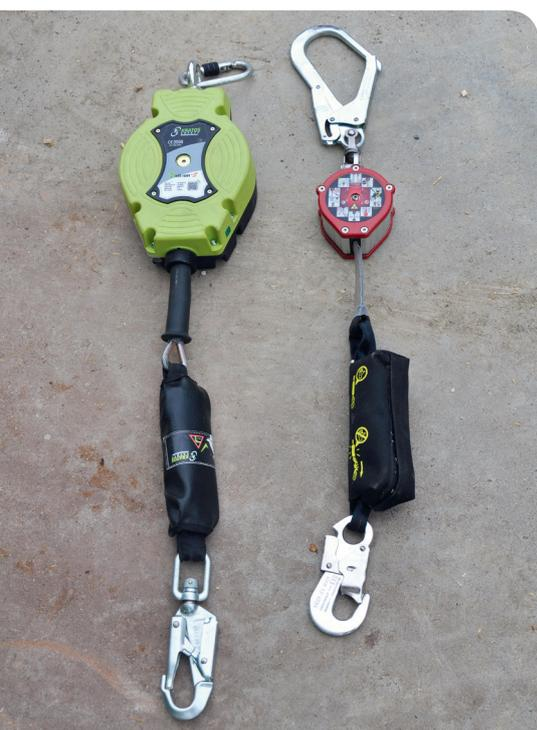
*Diversi sistemi anticaduta in altezza con cinghia o cavo d'acciaio.*
