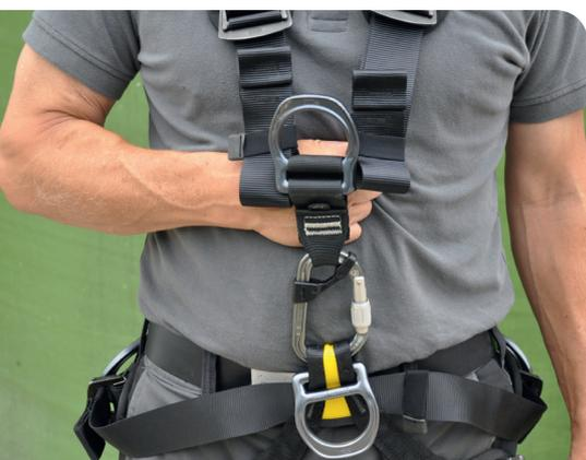
*Controllare con il pugno se l'imbracatura è stata stretta a sufficienza.*
