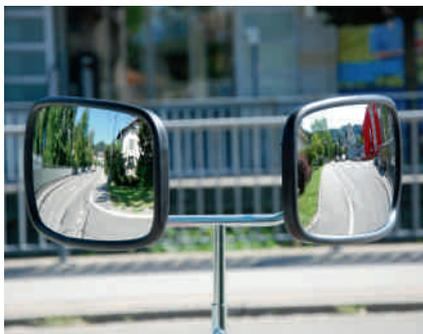
Specchi per la visione laterale montati nuovi devono avere ognuno, una superficie riflettente di almeno 500 cm<sup>2</sup> ed essere montati in orizzontale.
