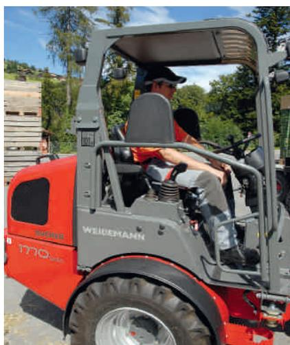
Dal 01.01.2010, i nuovi caricatori compatti devono avere un dispositivo di protezione e un dispositivo di trattenuta del conducente. A dipendenza del loro impiego, anche quelli più vecchi devono essere adattati.
