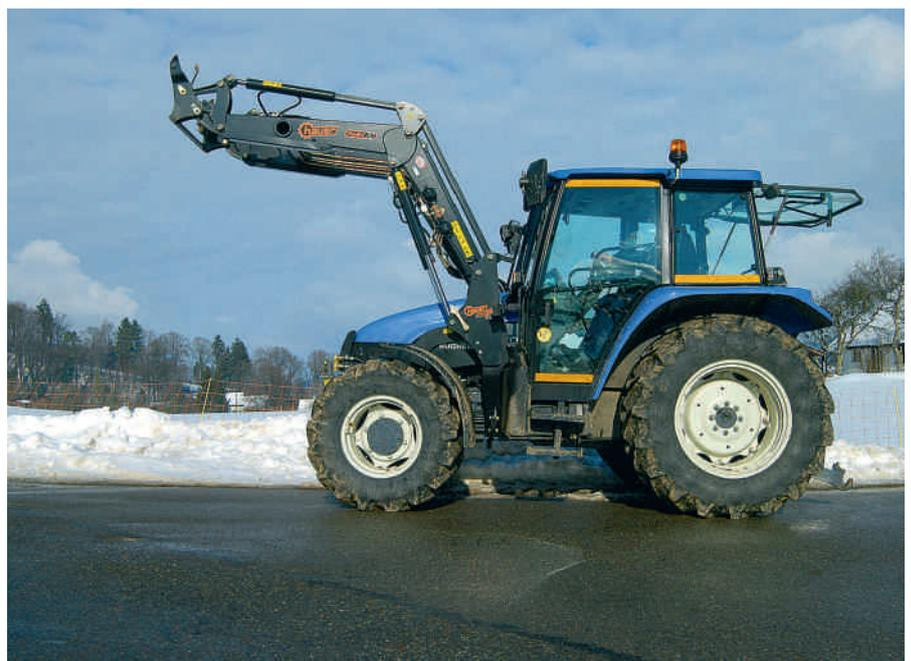
A dipendenza del tipo di caricatore, di trattore e di attrezzo, si deve scegliere se posizionarlo in basso o in alto. L'altezza di posizionamento del caricatore, influenza la visibilità, il baricentro, il comportamento in frenata e la stabilità del trattore, specialmente in curva. Non si possono trasportare merci sul caricatore frontale sulle strade pubbliche. L'altezza massima è limitata a 4 m.
