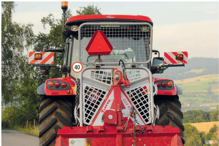
Al posto delle luci d'ingombro, si possono mettere i fanali di coda e gli indicatori di direzione, che inoltre possono sostituire quelli mascherati dall'attrezzo portato.
