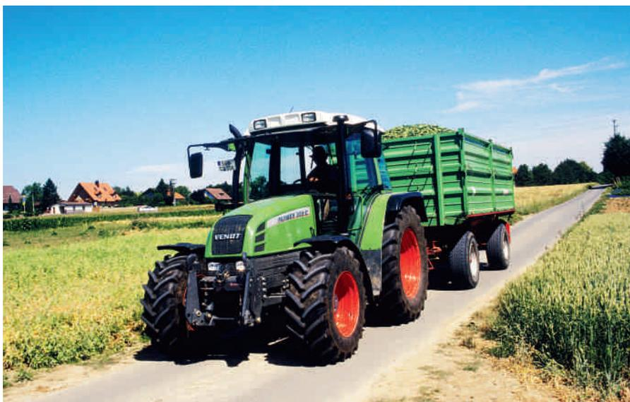
*È importante fare una frenata di prova prima di partire. In questo momento si riempie il serbatoio di accumulo pressione.*
