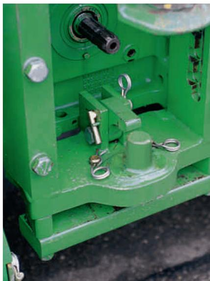
*Attacco basso con Piton-fix. L'attacco basso permette di usufruire del carico massimo di 3 t. Con carichi pesanti possono esserci dei contraccolpi.*
