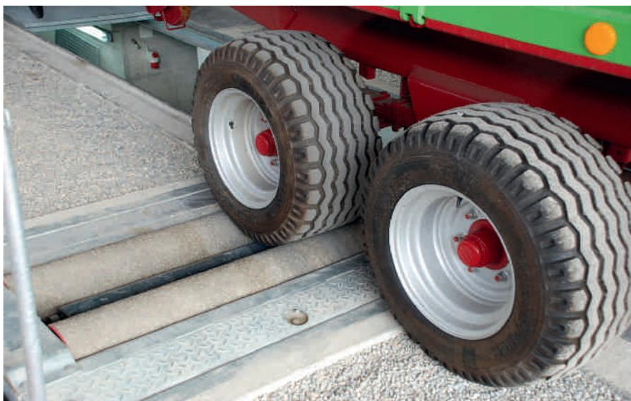
*I freni idraulici dei rimorchi devono essere regolati esattamente, per corrispondere a quelli del veicolo trattore. Un banco di prova con rulli permette il miglior controllo.*
