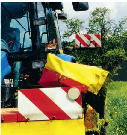
La visibilità di falciatrici rotanti e volta-fieno a trottola può essere aumentata se le tele di protezione sono gialle.
