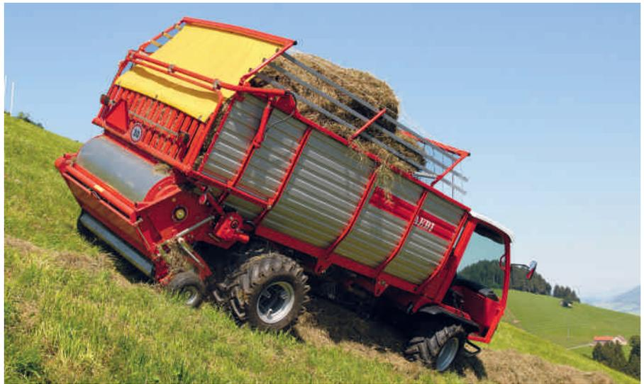
*I transporter con attrezzi portati hanno una ripartizione ideale del peso per i tragitti su strada e nel terreno. Se utilizzati senza attrezzi portati, quali veicoli di traino, sono pesanti sul davanti e necessitano dei contrappesi posteriori. Anche i transporter devono essere equipaggiati del segnale di veicolo lento.*
