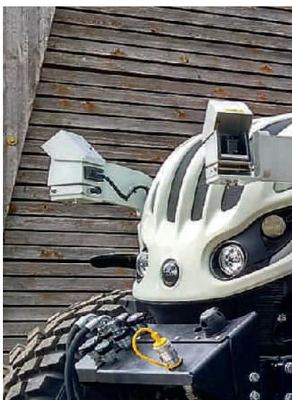
Le telecamere devono essere montate il più in avanti possibile. Se necessario possono essere retrocesse fino a 2,50 m, ad es. sul cofano del trattore.
