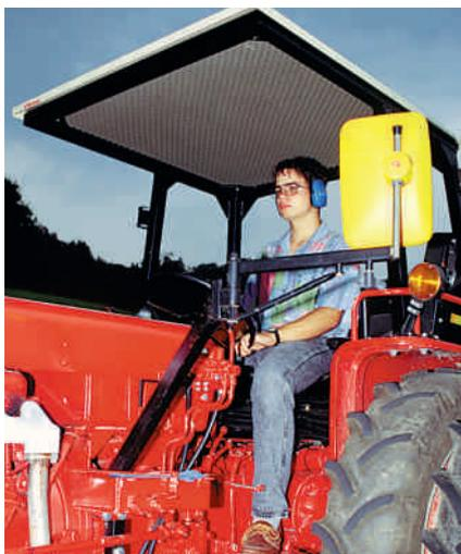
*Anche adatti per l'equipaggiamento a posteriori di vecchi trattori: telaio di sicurezza o arco di protezione. La cintura di sicurezza non può mancare!*
