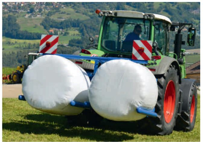
*Con dei sistemi di trasporto adatti, si possono trasportare delle balle fissate dietro al trattore. La larghezza delle balle non può essere superiore a 2.55 m, e l'apparecchio di trasporto non può essere più largo del trattore.*
