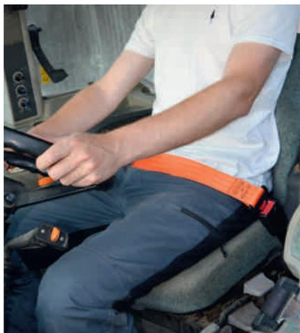
*Solamente con la cintura di sicurezza allacciata, il conducente ha la garanzia di rimanere sul sedile all'interno dello spazio di sicurezza in caso di ribaltamento e di avere buone probabilità di sopravvivere.*
