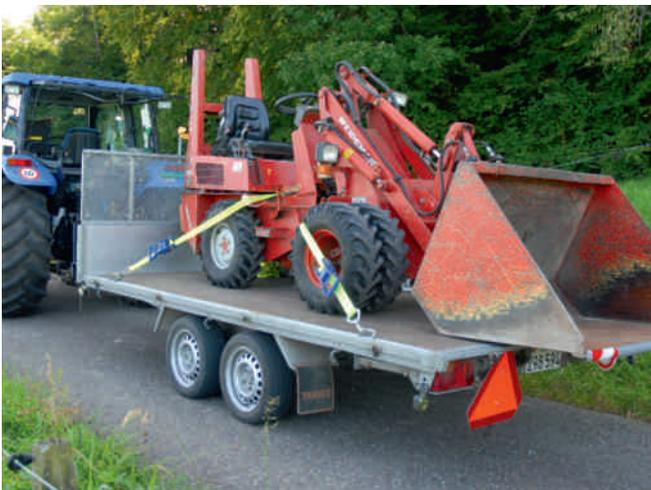
*Macchinari ed apparecchi trasportati, vanno sempre ben assicurati. Sono necessari dei punti di fissaggio solidi e di facile accesso.*
