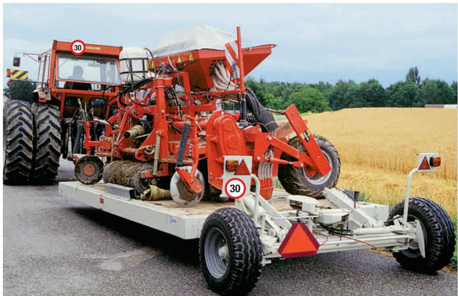
Un rimorchio comodo che si abbassa idraulicamente per trasportare l'attrezzo portato. Quando superano i 3,5 metri di larghezza, vanno trasportati sul lungo.
