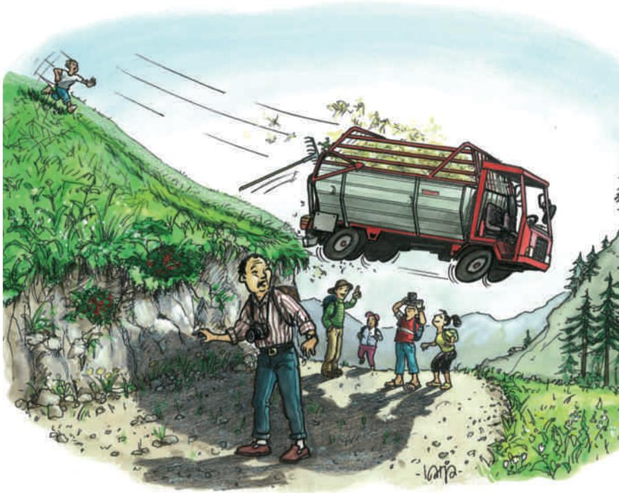
*Rispettate i limiti d'impiego sui terreni in pendenza. Se si staziona il transporter in pendenza, assicurarlo ad esempio con dei cunei. Spesso il freno a mano non basta.*
