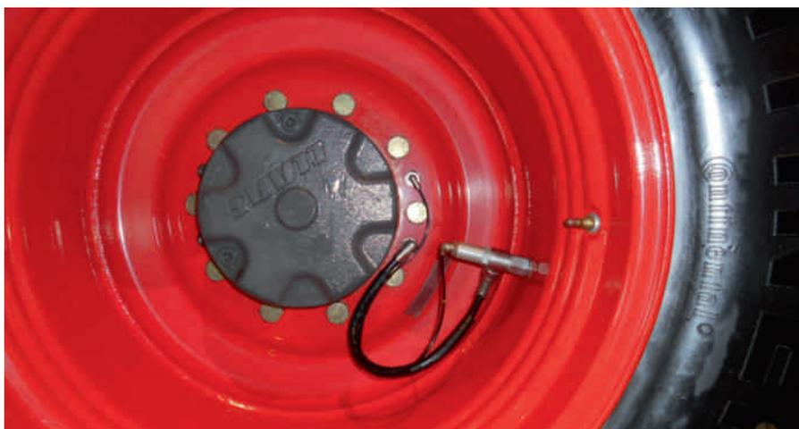
*Con un impianto di variazione della pressione, è possibile raggiungere in fretta la corretta pressione per la circolazione dopo l'impiego nel campo.*
