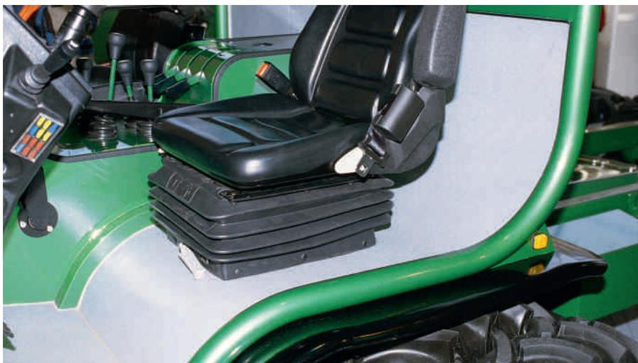
*Solo se si utilizzano le cinture di sicurezza, conducente e passeggero rimangono al sicuro nello spazio vitale in caso di ribaltamento. Montare le cinture se mancano.*
